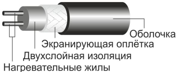
Рисунок 3 - Устройство нагревательного провода.
